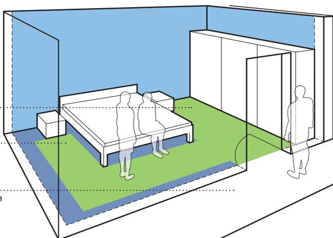
Zimmertür: Durchgangsbreite mind. 80 cm, kein unterer Türanschlag und Schwellen; Türdrücker: Gut greifbar, mit geringem Kraftaufwand zu Öffnen und zu Schließen
